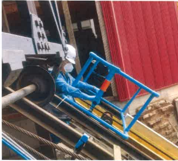
Figura N°16: Simulación del paso del eje de la cabina por los 2 sensores de desaceleración.
