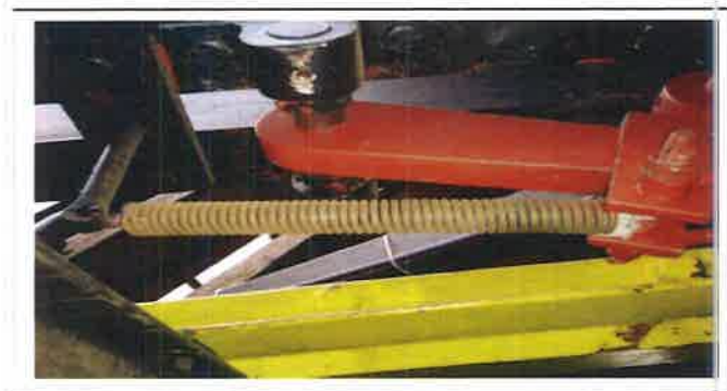
Figura 4: Resorte del sistema de enclavamiento
