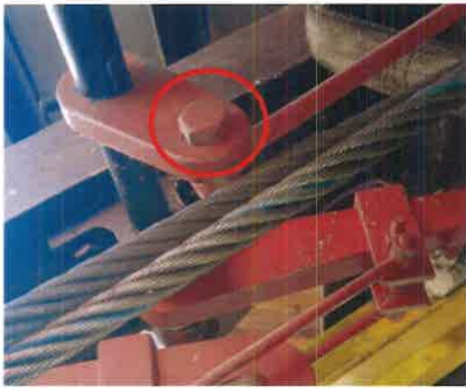
Figuras 26 y 27: Pernos en los extremos de la barra de unión (placa-eje).
