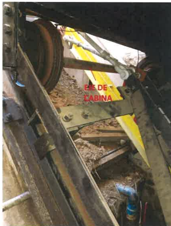
Figura N°12: Eje de cabina (cabina 2).
