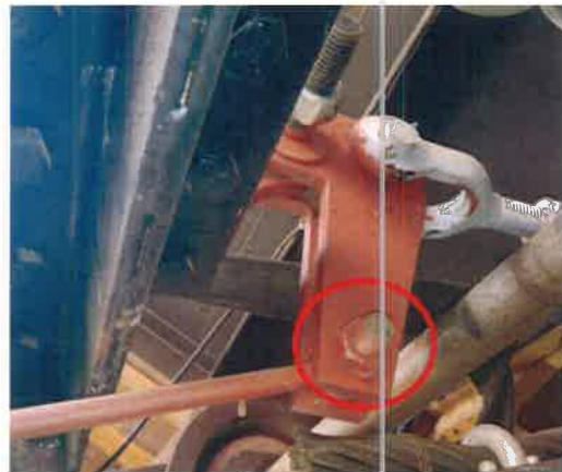
Figuras 26 y 27: Pernos en los extremos de la barra de unión (placa-eje).
