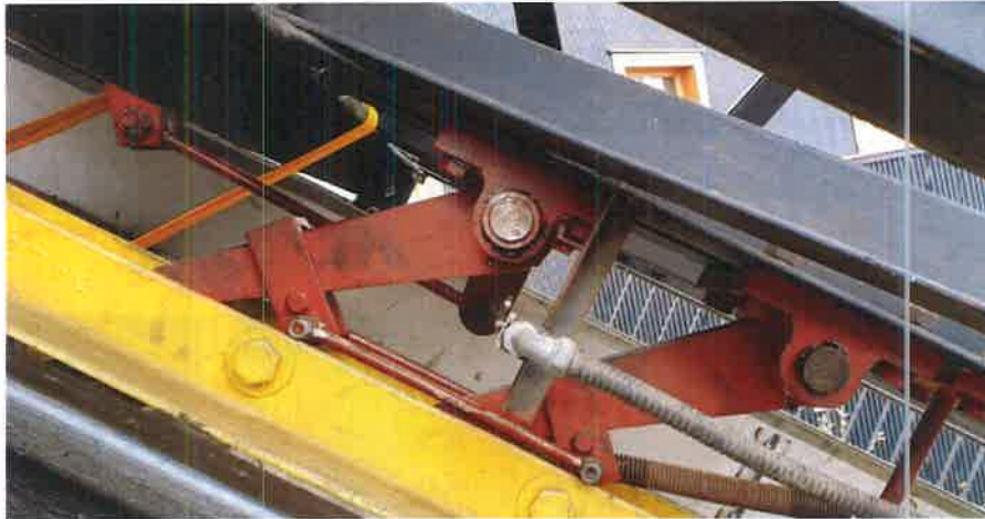
Figura 22: Descenso de los ganchos de la cabina 1.
